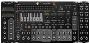
Wie bereits angekündigt enthält Version **0.6.13** von **Impromptu Modular** den 4-Spur Phrase Sequencer **Foundry**, außerdem noch das 4-CV Display Modul **FourView**. <https://github.com/MarcBoule/ImpromptuModular>
